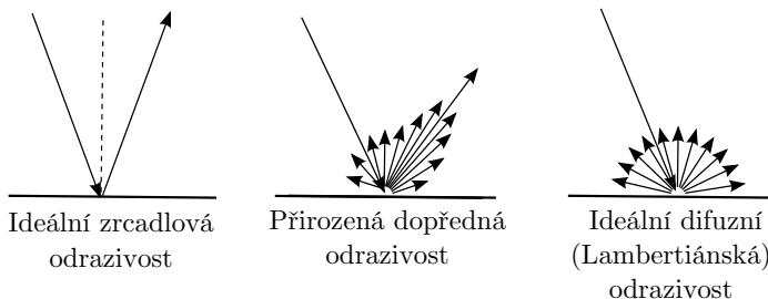
**Obrázek 1.5** Typy odrazivosti podle prostorové distribuce odraženého záření.
